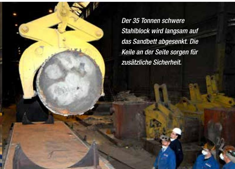
Der 35 Tonnen schwere Stahlblock wird langsam auf das Sandbett abgesenkt. Die Keile an der Seite sorgen für zusätzliche Sicherheit.
