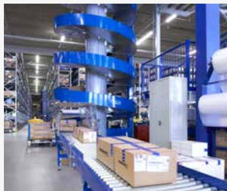
▲ Kleine Ersatzteile werden in einem großen Zwischengeschoss mit 5.000 m<sup>2</sup> gelagert und über einen Spiralförderband nach unten geschickt.
