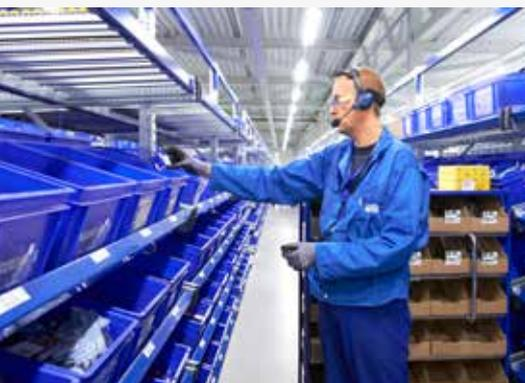
▲ Bei den sprachgesteuerten Entnahmeanweisungen werden die Bestellungen nicht über ein Display kommuniziert, sondern über eine Computerstimme direkt an den Mitarbeiter, der dann mit seiner Stimme die Bestellung bestätigt.
