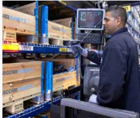
▲ Die Entnahmereihenfolge wird in Reihenfolge der Lagerplätze auf dem Monitor angezeigt. Der Monitor ist drahtlos mit dem Logistiksystem verbunden. Die Bestellung wird durch Scannen des Lagerplatz-Codes bestätigt.
