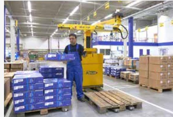
▲ Ein speziell für PACCAR entwickeltes ergonomisches Werkzeug stellt sicher, dass die körperliche Belastung der Mitarbeiter so weit wie möglich reduziert wird, wenn große oder schwere Ersatzteile entnommen werden müssen.
