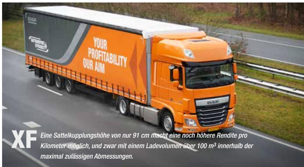
**XF** Eine Sattelkupplungshohe von nur 91 cm macht eine noch hohere Rendite pro Kilometer moglich, und zwar mit einem Ladevolumen uber 100 m<sup>3</sup> innerhalb der maximal zulassigen Abmessungen.
