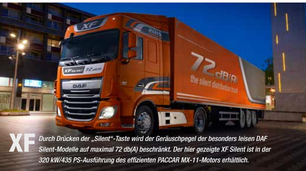
**XF** Durch Drücken der „Silent“-Taste wird der Geräuschpegel der besonders leisen DAF Silent-Modelle auf maximal 72 db(A) beschränkt. Der hier gezeigte XF Silent ist in der 320 kW/435 PS-Ausführung des effizienten PACCAR MX-11-Motors erhältlich.
