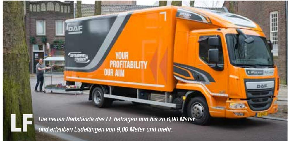
**LF** Die neuen Radstände des LF betragen nun bis zu 6,90 Meter und erlauben Ladelängen von 9,00 Meter und mehr.
