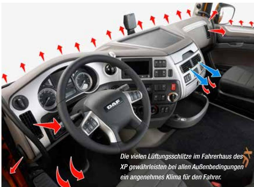
*Die vielen Lüftungsschlitze im Fahrerhaus des XP gewährleisten bei allen Außenbedingungen ein angenehmes Klima für den Fahrer.*
