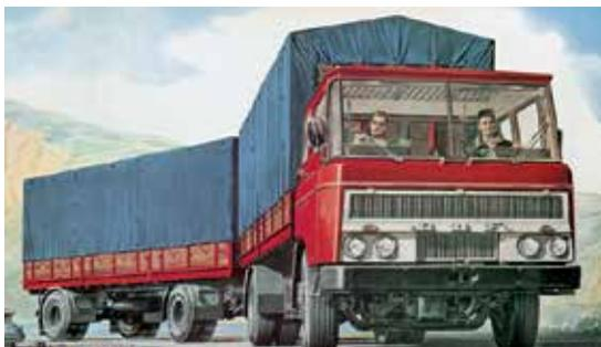
Der DAF 2600 war mit vier Doppelscheinwerfern ausgestattet. Die äußeren Scheinwerfer dienen als Abblendlichter und die inneren liefern das Fernlicht. Wenn eine Lampe für das Abblendlicht ausfiel, konnte sie der Fahrer problemlos durch die Glühbirne daneben ersetzen.
