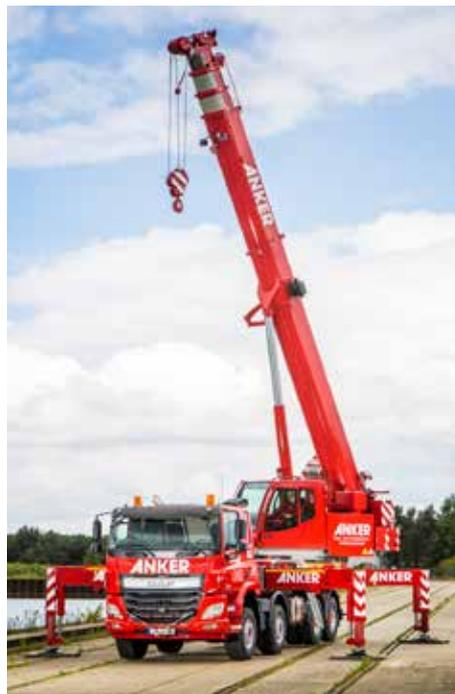
*Die 8x4 CF-voertuigen met slaapcabine zijn voorzien van een kraanopbouw met een reikwijdte van maar liefst 35,20 meter en een hefvermogen van 40 ton.*
