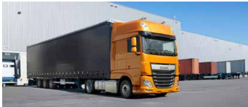
Der XF Low Deck mit Super Space Cab wurde mit einem neuen Dachspoiler ausgestattet, der die Aerodynamik optimiert und den Kraftstoffverbrauch sowie die CO<sub>2</sub>-Emissionen im Vergleich zum Dachspoiler der bereits erhältlichen Low Deck-Version um 1,5 % senkt. Die neuen Low Deck-Sattelzugmaschinen von DAF haben einen Radstand von 3,60 oder 3,80 Metern und sind mit den hochmodernen PACCAR MX-11 Motoren mit 10,8 Liter Hubraum oder den PACCAR MX-13 Motoren mit 12,9 Liter Hubraum ausgestattet.
